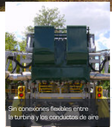
Sistema de doble turbina trasero para el caudal de aire.
