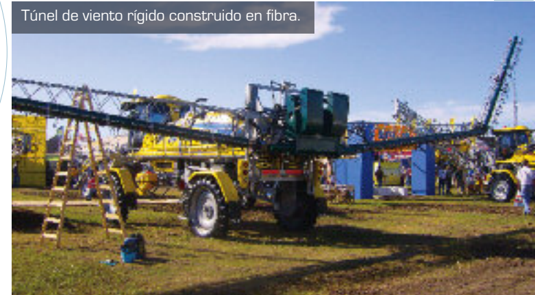
Sistema de doble turbina trasero para el caudal de aire.
