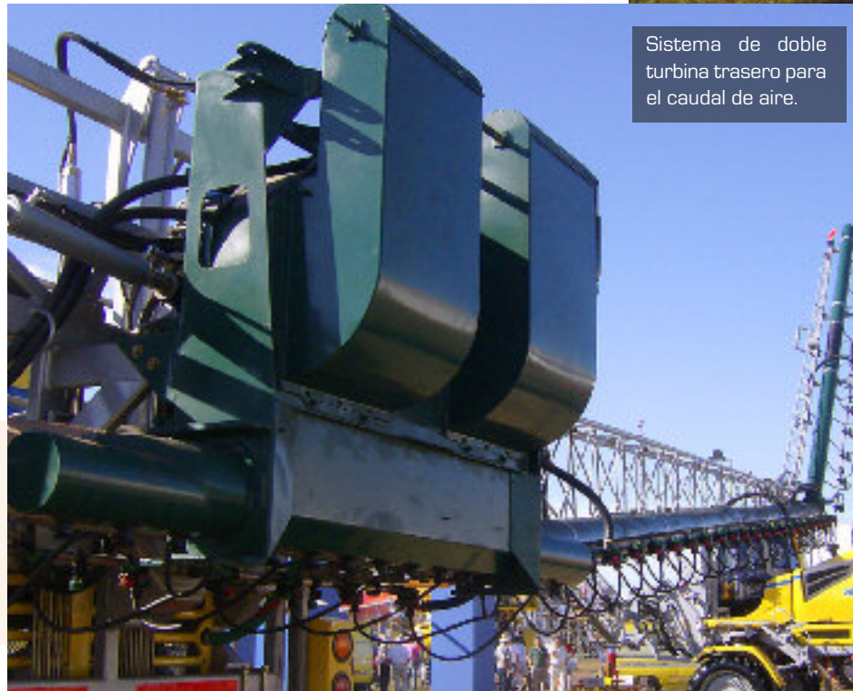
Sin conexiones flexibles entre la turbina y los conductos de aire
